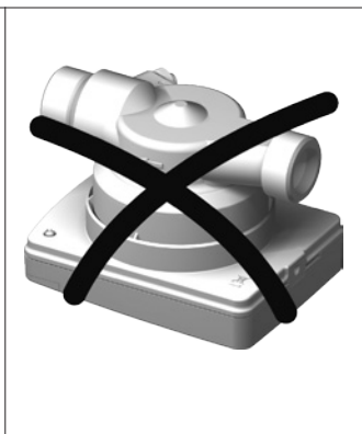
Montaż z przechyleniem poziomym Nie montować do góry nogami!
